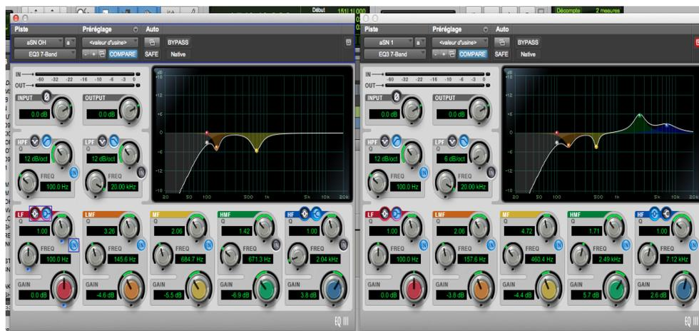
Fig. 39: Traitements fréquentiels sur les pistes de caisse claire. Gauche : bus overhead et ambiance. Droite : bus des pistes de proximité (capture d'écran)
