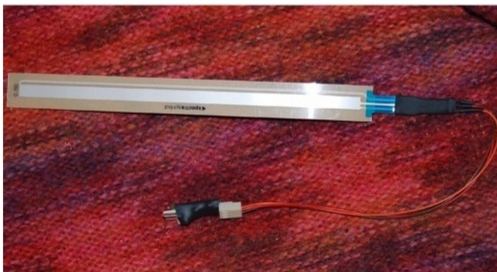
Figure 2.5: Photographie d'un potentiomètre linéaire souple
