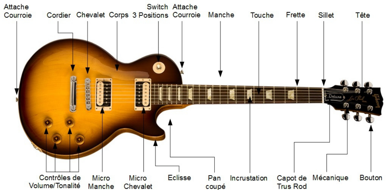
Figure 2.8: Éléments constitutifs de la guitare électrique
