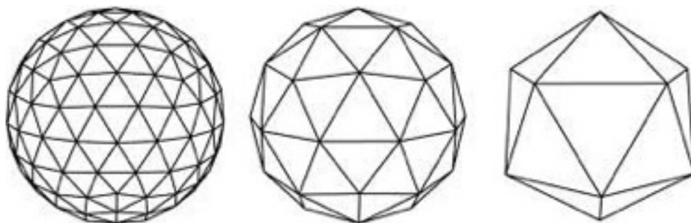
Fig. 3.1 : Raffinement du maillage d'une sphère par décimation de vertex
