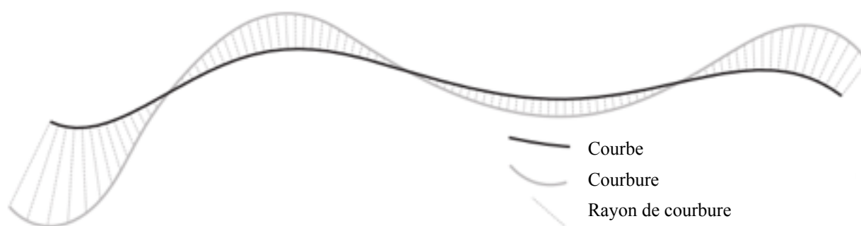
Fig. 2.13 : Illustration de la courbe et du rayon de courbure d'une coupe transversale d'un objet 3D [Alonso-Arevalo et al., 2012]
