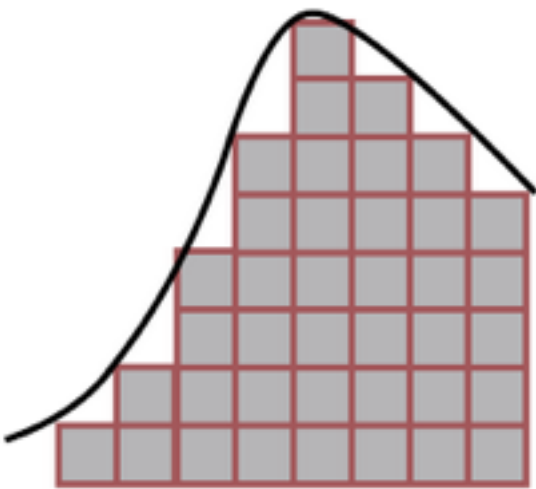
Fig. 2.18 : Représentation 2D du lissage des voxels par l'isosurface
