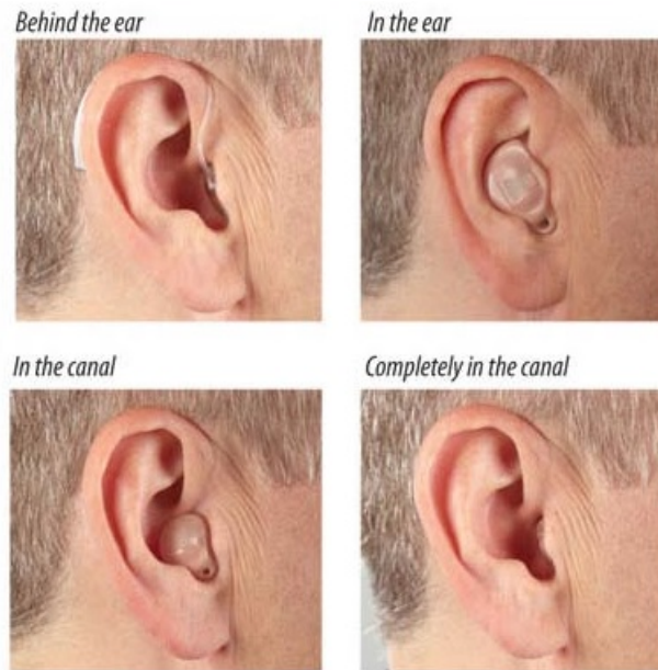
FIGURE 4 – Photographies des quatre formats de prothèses auditives, des plus visibles au plus discrètes : en haut : derrière l’oreille (à gauche), dans l’oreille (à droite) ; en bas : dans le canal (à gauche), complètement dans le canal (à droite). D’après [18], p. 1.
