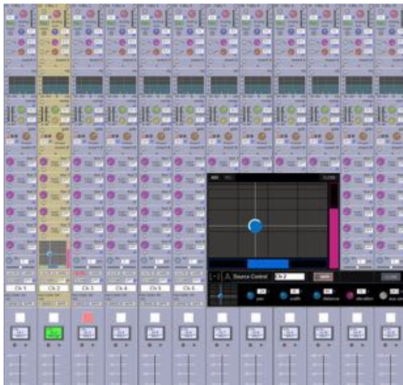
FIGURE 4.1 – Capture de l'écran d'une console DiGiCo montrant l'intégration d'un système permettant le contrôle du processeur L-ISA (L-Acoustics). Sur la console, les potentiomètres visibles à l'écran sont alignés avec des encodeurs rotatifs de la surface de contrôle. (Source : Service presse de DiGiCo, « L-ISA Source Control Available On DiGiCo SD Consoles », 11 avril 2018. Consulté le 8 avril 2019. https://www.digico.biz/docs/latest_news/EVkJFuVuApEDLWmHmHn.shtml ).
