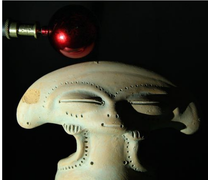
FIGURE 2.3 – Photographie issue de l’acquisition RTI du fac-similé d’une statuette amérindienne, on distingue la boule réfléchissante permettant d’estimer la position des sources lumineuses
