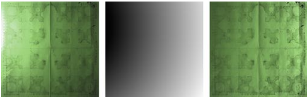
FIGURE 3.14 – Images issues de l'acquisition RTI réalisée sur le dessin de Sangallo - Compensation de l'intensité des pixels en fonction de la distance sujet-source. à droite, l'image originale. à gauche l'image compensée, au milieu la carte de distance calculée par notre programme
