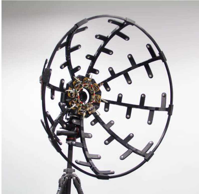
FIGURE 2.1 – Prototype de dôme d’acquisition RTI conçu et réalisé par Eloi Gattet, ingénieur de recherche au laboratoire MAP. Le dispositif possède 48 LEDs réparties en 8 bras et mesure 80 cm de diamètre.
