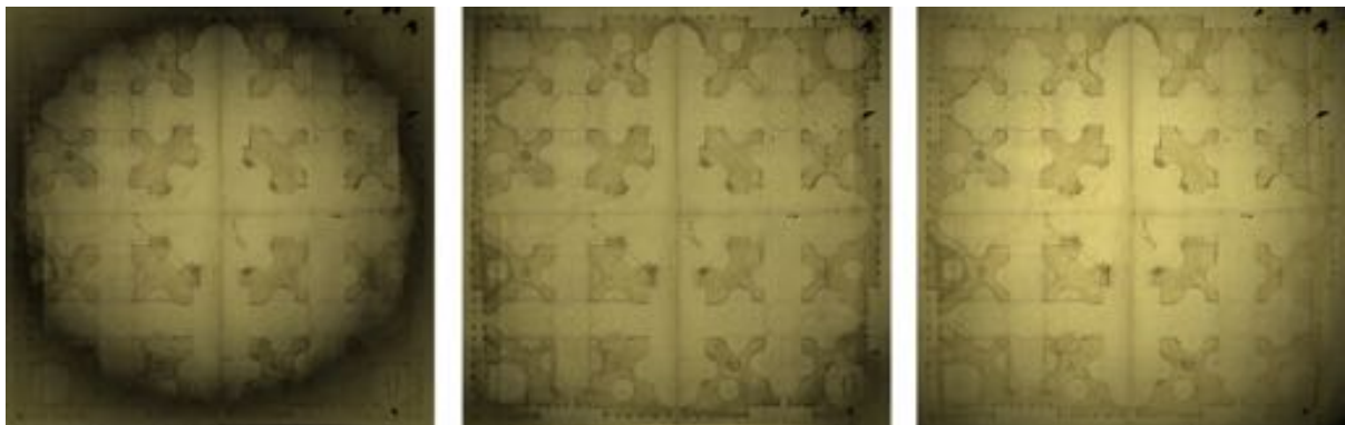
FIGURE 3.17 – Rendus RTI diffuse gain du dessin de Sangallo générée par le logiciel RTIviewer - Comparaison des résultats (de droite à gauche) : sans calibration, calibration des directions seules, calibration complète
