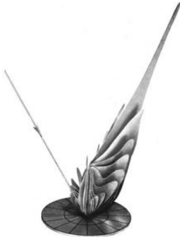
FIGURE 1.7 – Sculpture représentant la BRDF d’une surface en aluminium pour un angle d’incidence de 33^\circ
