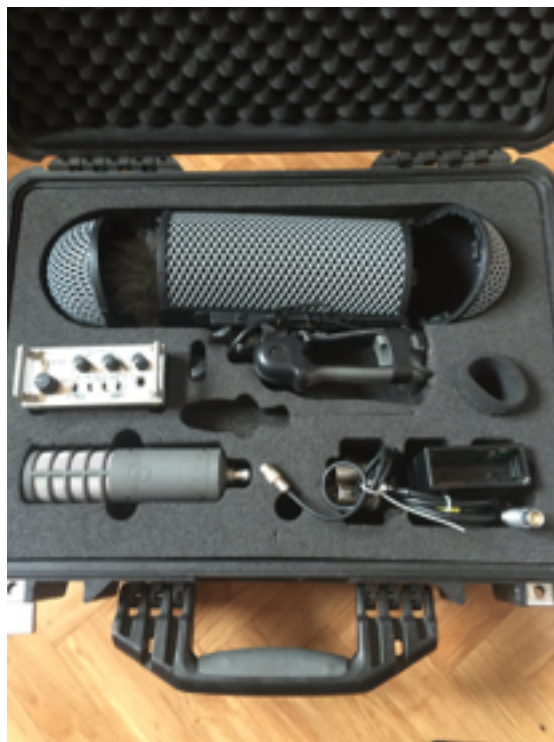
Valise du SoundField ST350, avec convertisseur Hardware format A vers format B, mis à la location par Tapages et Nocturnes
