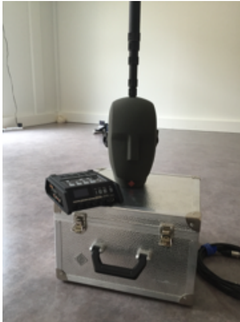
Enregistreur Roland R44 et tête Neumann KU-100 sur perche, gracieusement mis à disposition par le CMAP
