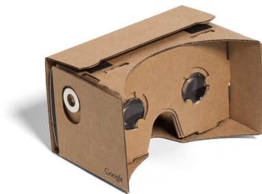
fig11. le Google Cardboard est un simple support en carton qui incorpore deux lentilles sur lequel on vient poser son smartphone. Des versions plus élaborées permettent de régler l'écartement des lentilles et la mise au point, pour corriger certains problèmes de vue
