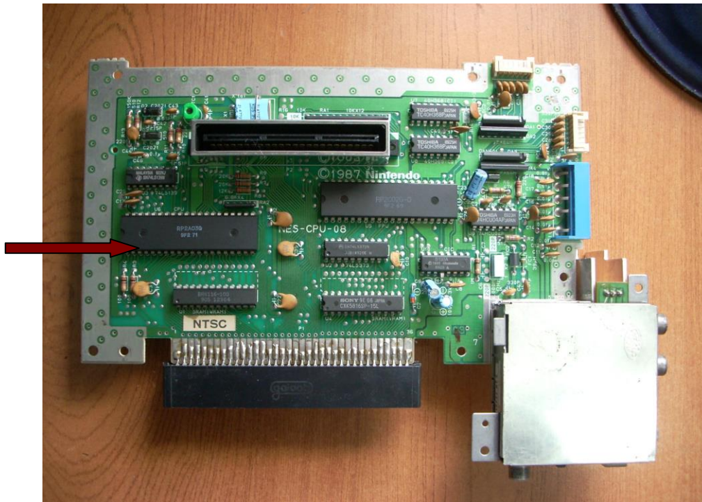
Illustration 6: Une carte mère de NES dans sa version NTSC. La position du Ricoh 2a03 est indiquée par une flèche rouge.
