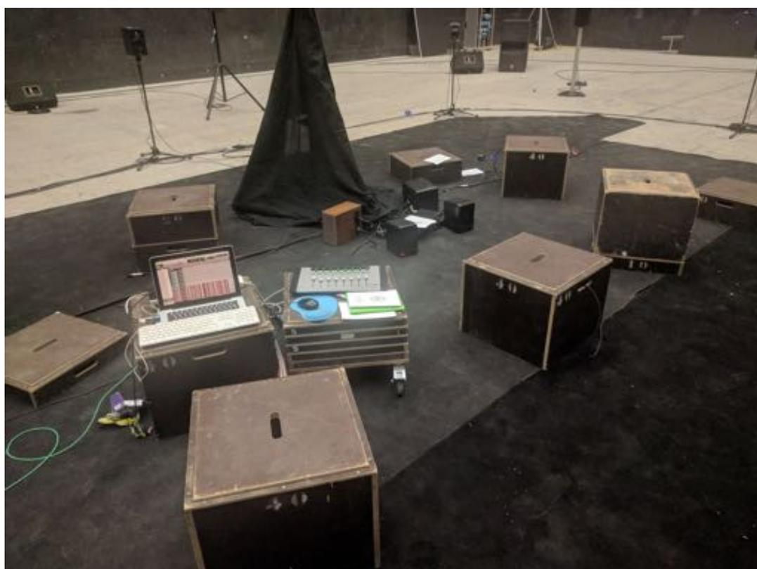
FIGURE 3.7 – Zone d'écoute pendant le mixage avec une petite surface de contrôle au centre pour affiner les rapports entre les différents plans et couronnes sonores par l'utilisation de VCAs (Voltage Controlled Amplifier) au sein de la session Protools qui permet d'utiliser les fonctions d'automation.
