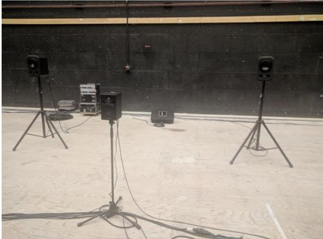
FIGURE 3.10 – La disposition en quinconce des enceintes avec une msp3 de la **couronne A** sur pied micro au premier plan.
