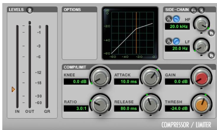
Interface d'un Compresseur / Limiteur du logiciel *ProTools*
