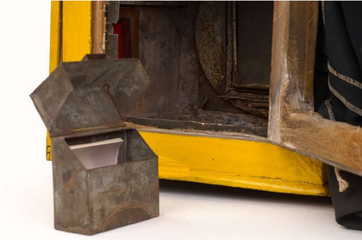
Fig. A10. Appareil laboratoire utilisé sur l'Acropole par Pantelis Kapetanos entre 1933 et 1993, vue de la boîte de papier amovible en zinc. Collection du musée Nicéphore Niépce, ville de Chalon-sur-Saône.
