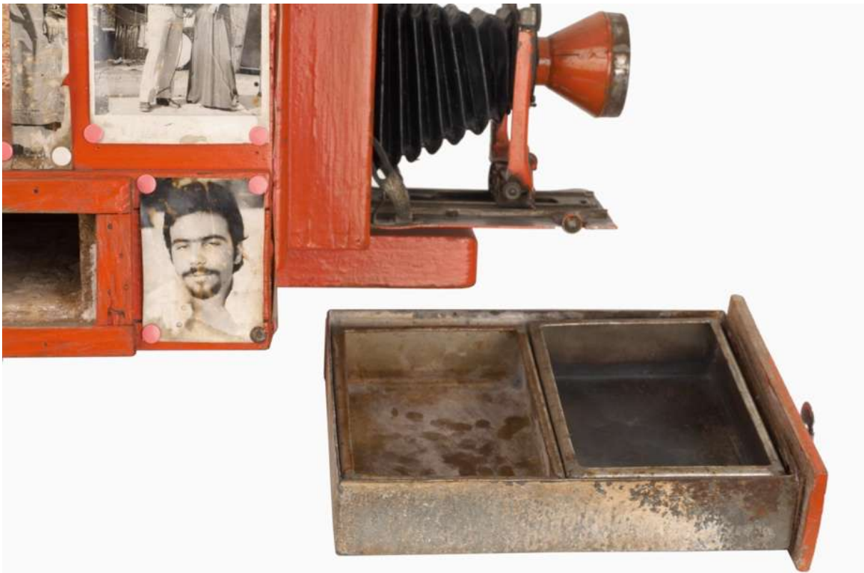
Fig A6. Appareil laboratoire utilisé de 1925 à 1985 au Péloponnèse et à Athènes. Tiroir comprenant les deux bacs de chimie. Collection du musée Nicéphore Niépce, ville de Chalon-sur-Saône.
