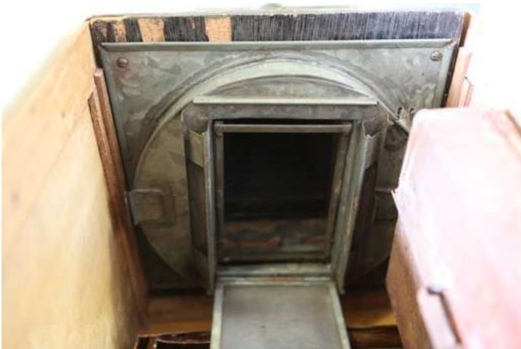
Figures annexes 4. Appareil laboratoire utilisé sur l'Acropole par Pantelis Kapetanios entre 1933 et 1993, vue du système rotatif du dépoli en zinc similaire aux appareils laboratoires français de l'époque. Collection du musée Nicéphore Niépce, ville de Chalon-sur-Saône.
