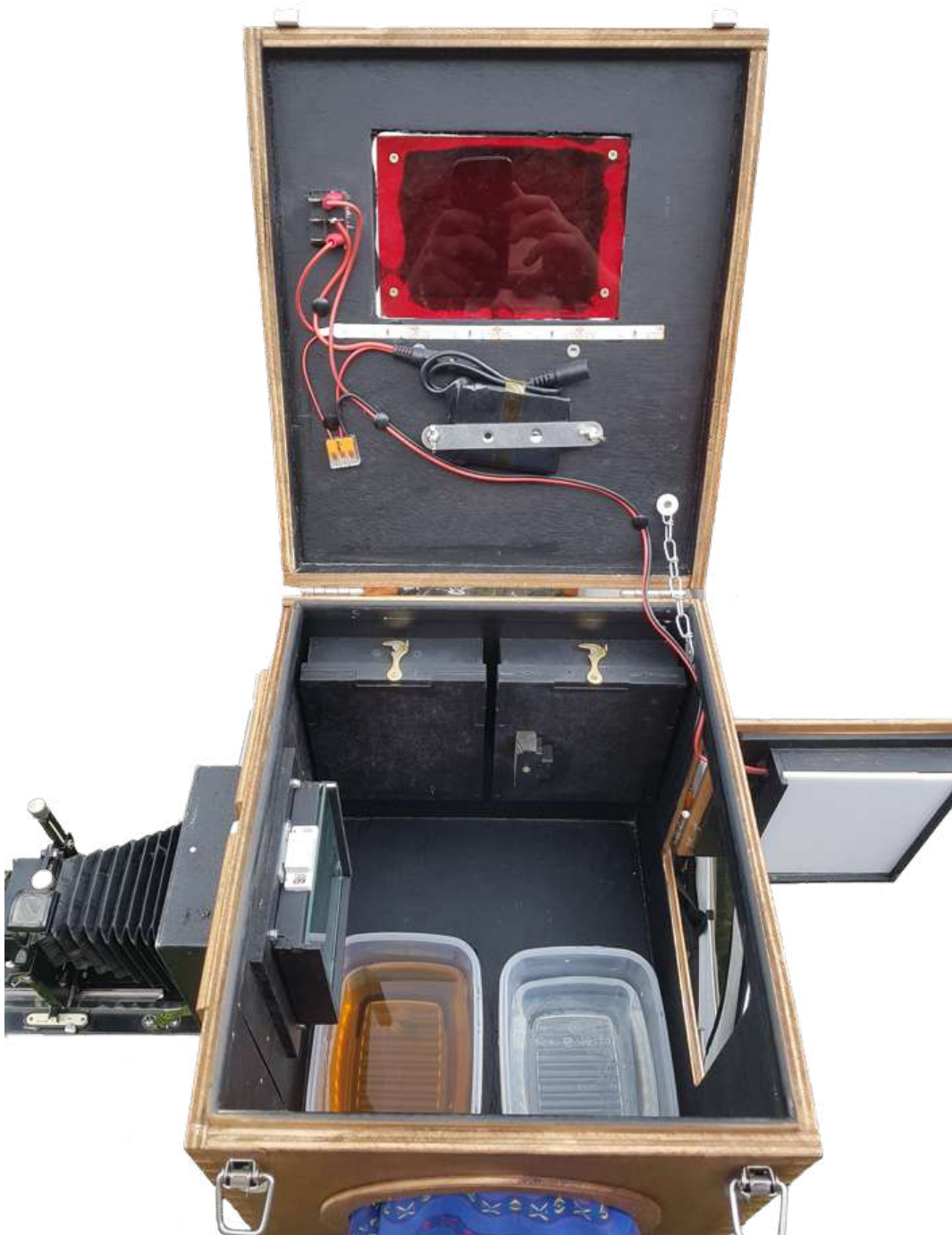
Fig A9. Camera-laboratoire personnelle équipée de LEDs rouges et d'un plexi inactinique pour contrôler le développement.
