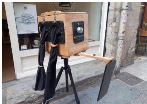
Fig. 19. Camera-laboratoire à mise au point interne fabriquée en 2023 par Benoît Caponi. Elle a été fabriquée à partir de bois massif de hêtre et dispose de deux manchons.
