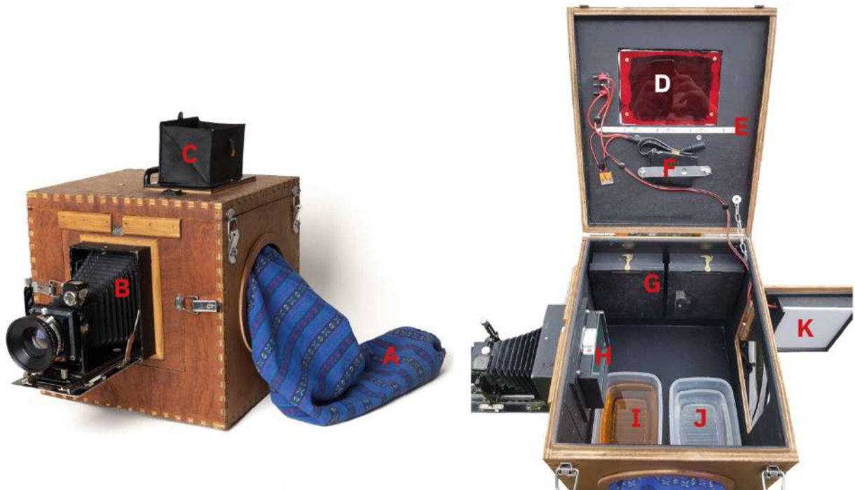
Fig. 17. Antoine BERTRON, camera-laboratoire à mise au point externe utilisée lors du BICYCLOPHOTOTROC . A : manchon, B : chambre folding 9 x 12 cm, C : visière issue de la chambre folding, D : plexiglass inactinique, E : LEDs rouges, F : batterie, G : boîtes à papier, H : système dépoli et contacteur, I : bac de révélateur, J : bac de fixateur, K : LEDs blanches pour effectuer le tirage par contact.
