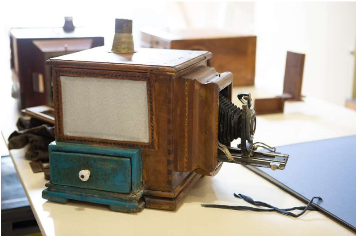
Fig A8. Appareil laboratoire « la Magnifique ». L'élément cylindrique au-dessus de la camera-laboratoire permet le contrôle du développement. Collection du musée Nicéphore Niépce, ville de Chalon-sur-Saône.
