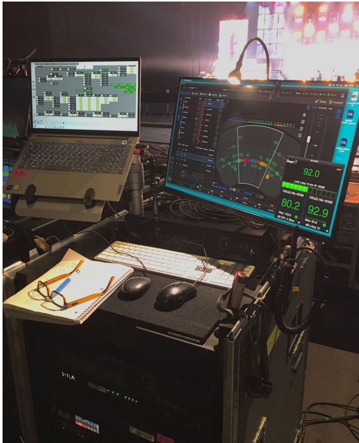
Poste de travail de Vladimir en façade : poste de gauche gérant les amplis de la façade et poste de droite gérant le moteur de spatialisation. On devine le processeur L-ISA dans le rack en dessous (Nancy, mars 2023)
