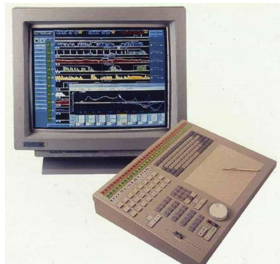
Figure 2.48 : diapositive présentant le terminal couleur, couplé à la tablette graphique
