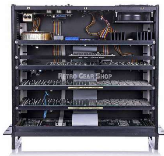
Figure 2.40 : construction modulaire de l'IM90. Les cartes sont plus petites que sur le DHM et rangées sur des rails, facilitant les mises à jour, le travail de maintenance et la robustesse globale du système (photo d'un exemplaire en vente au Retro Gear Shop)
