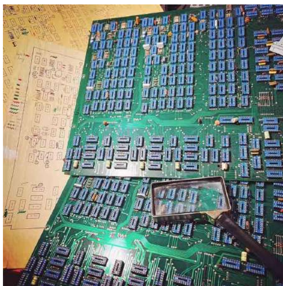
Figure 2.36 : cartes partiellement peuplées, mettant en lumière le nombre exceptionnel de circuits TTL (source : Jonathan Prager)
