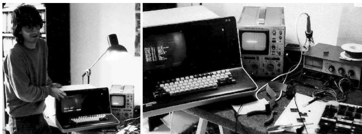
Figure 1.27 : un des frères Fernandez devant un terminal EXORset30 de développement pour Motorola 6809, microprocesseur que l'on retrouve dans le RSF PolyKobol II (Verpeaux, 1985)
