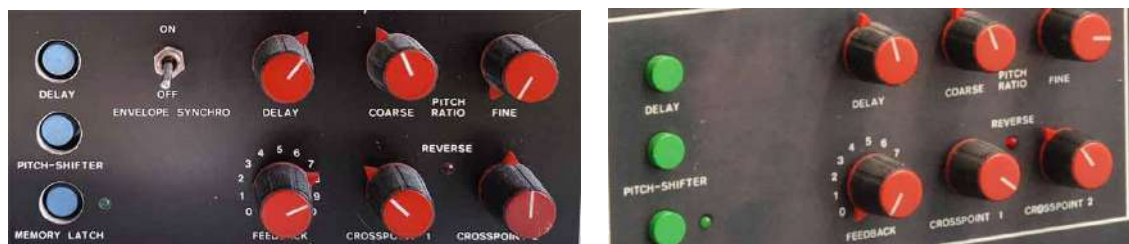
Figure 2.34 : révision 1 (gauche), révision 2 (droite) : disparition de l'interrupteur ‘Envelope Synchro’
