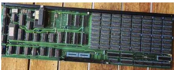
Carte DSP intégrant 64 des 128 circuits de RAM (Source : Jonathan Prager)
