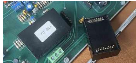
Figure 2.54 : blocs contenant les circuits actifs
