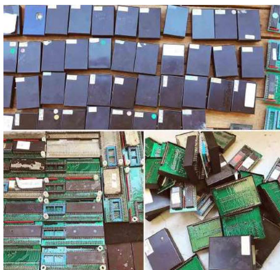
EPROMS du CPU moulées dans l'IM90. (Source : Jonathan Prager)
